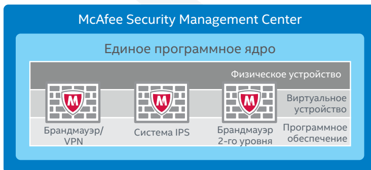
Рис. 1. McAfee NGFW поддерживает три разных функциональных роли и три варианта развертывания.
